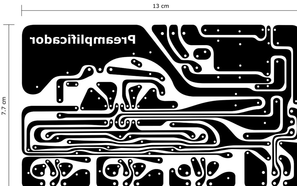
Circuito impreso en modo espejo para impresión con la técnica de planchado
