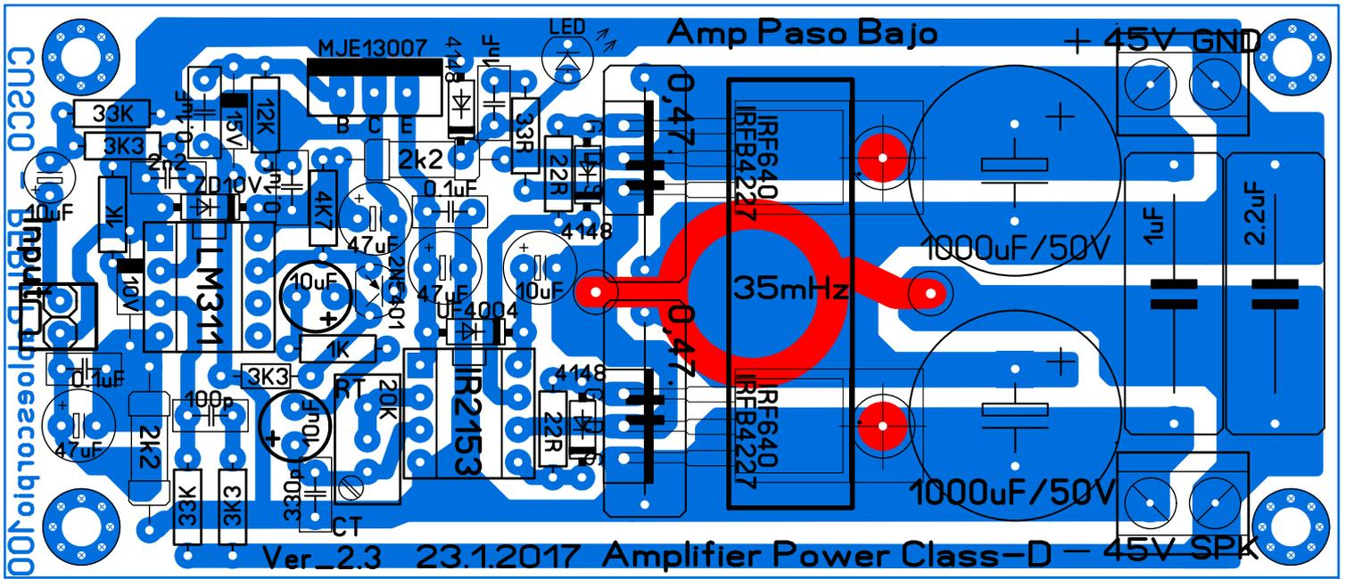
COMO INDUCTOR DE SALIDA USE EL EI33 A UNA FRECUENCIA DE 35uHz
